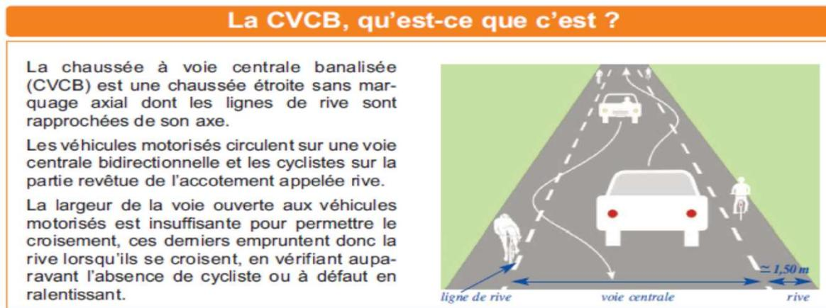
la route de la rue de Hésingue devient une CVCB (chaussée à voie centrale banalisée). Il faudra également revoir le marquage en jaune le long de la voie rouge et les panneaux d'interdiction de stationner pour éviter que ce trottoir « voie rouge » devienne du stationnement.
